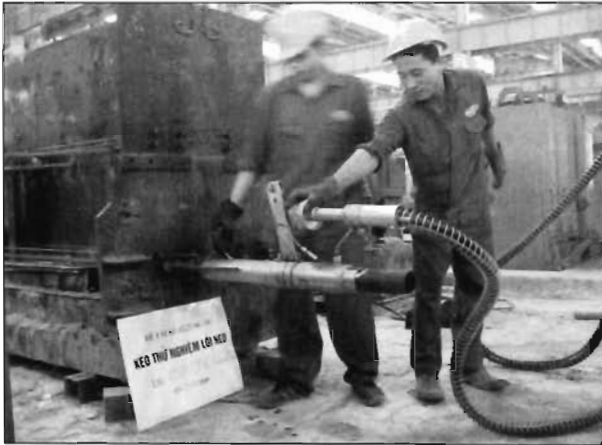
Hình 6. Thử kéo tạo Công ty Bê tông Xuân Mai
