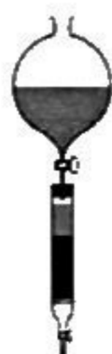
Hình 1. Cột trao đổi cation làm mềm nước.
