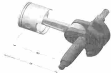
Hình 3. Mô hình CAD trong PTC Creo của cơ cấu tay quay con trượt
