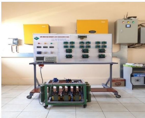
Hình 14. Mô hình thực nghiệm bộ nghịch lưu cascaded 5 bậc
