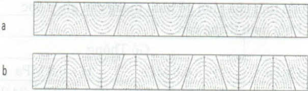
Hình 7. Phương án xếp phôi gỗ hình thang khi phay ngón ghép
