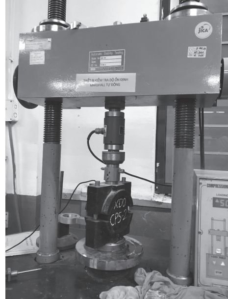
Hình 3.3: Thí nghiệm độ ổn định Marshall
