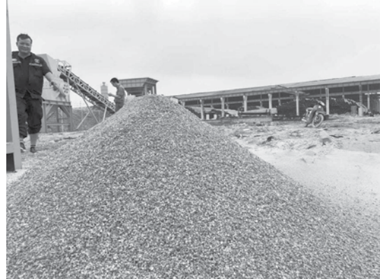
Hình 1. Cốt liệu lớn tái chế từ bê tông cũ
