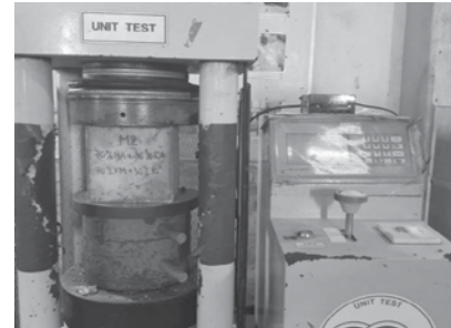
Hình 3. Thí nghiệm nén mẫu bê tông
