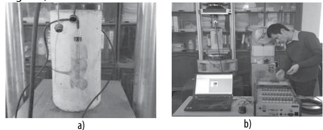
Hình 4. Thí nghiệm mô đun đàn hồi bê tông
