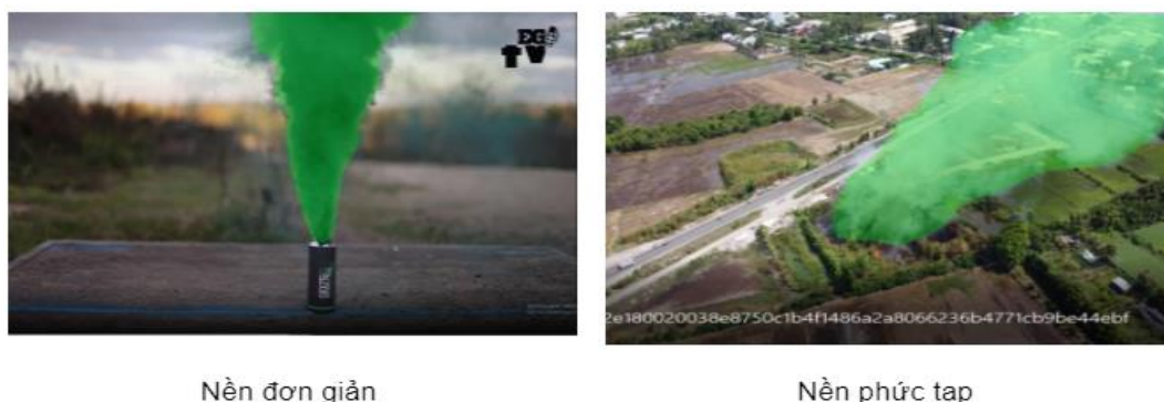
Hình 3. Điều kiện thử nghiệm. Nền đơn giản (trái) với 1565 khung và nền phức tạp (bên phải) với 1230 khung hình
