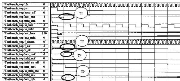
Hình 2.5.1. Timing của hệ thống khi đóng điện lần đầu
