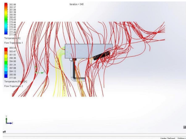
Hình 8. Dòng không khí đi vào và đi ra khỏi buồng ngưng tụ nước
