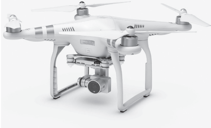
▲ Hình 2. Thiết bị bay chụp ảnh trên cao UAV (DJI Phantom 3)
