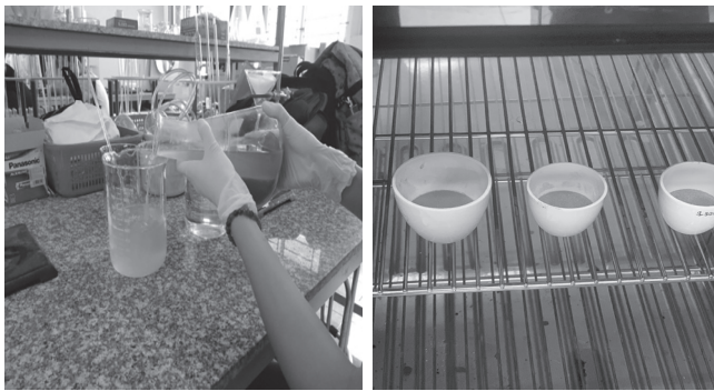
▲ Hình 5. Quá trình lọc rửa ▲ Hình 6. Sấy tro bay 105°C trong tủ sấy
