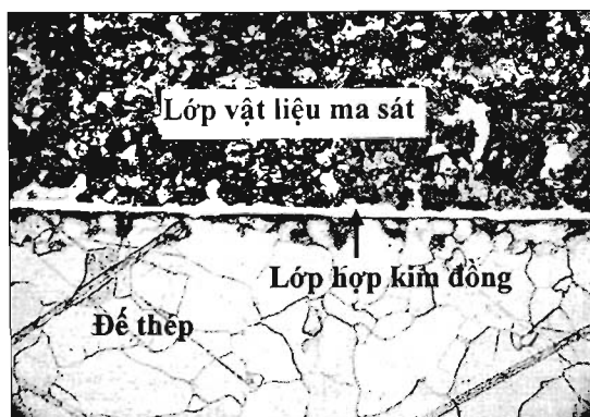
Hình 6: Cấu trúc mặt cắt ngang đế thép - vật liệu ma sát sau khi hàn; HVQH; tấm thực Nital
