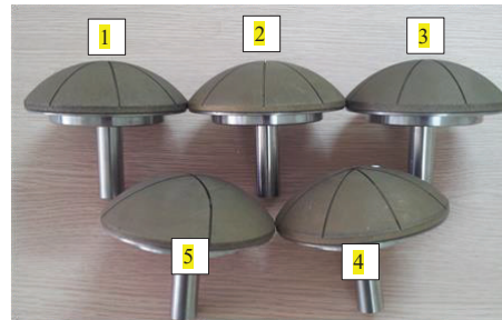
Hình 5. Nắm mài kim cương (5 loại nắm mài khác nhau tương ứng với 5 nguyên công mài mịn từ 1 tới 5).
