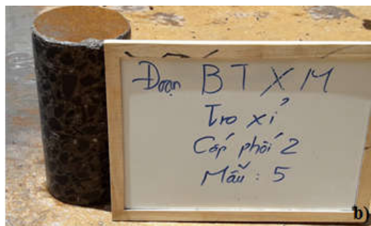
Hình 8: Lấy mẫu hiện trường. a) mẫu đúc trong khi thi công; b) mẫu khoan sau thi công 28 ngày.
