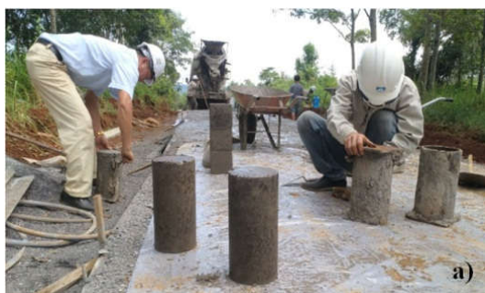
Hình 8: Lấy mẫu hiện trường. a) mẫu đúc trong khi thi công; b) mẫu khoan sau thi công 28 ngày.
