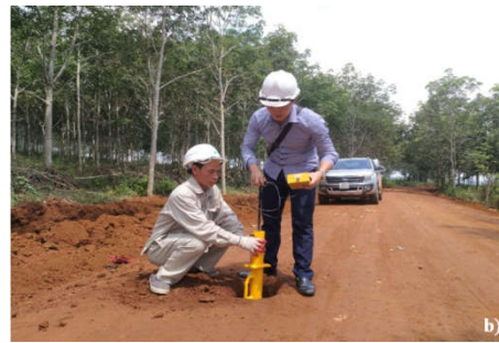
Hình 6: Kiểm tra chất lượng nền đường. a) Đào hố kích thước 30x30x20 cm; b) Thí nghiệm CIV
