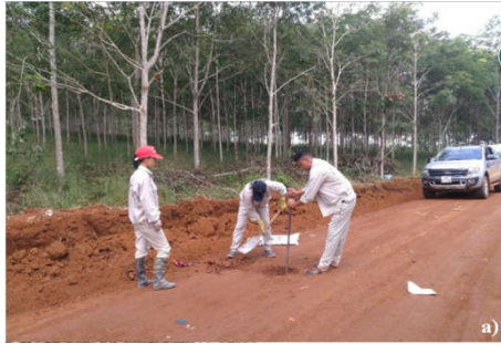
Hình 6: Kiểm tra chất lượng nền đường. a) Đào hố kích thước 30x30x20 cm; b) Thí nghiệm CIV
