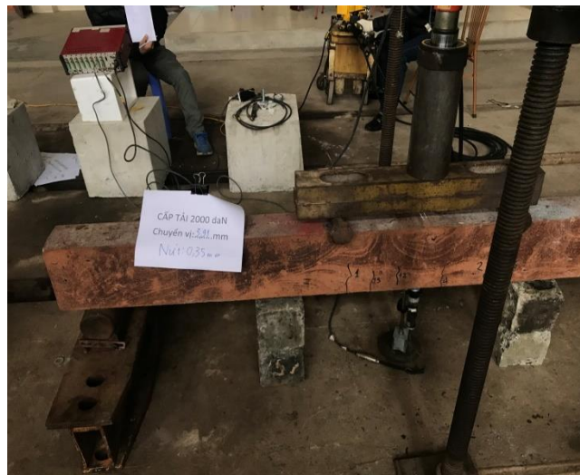
Vết nứt rộng 0,35mm, tương ứng với cấp tải 20 kN
