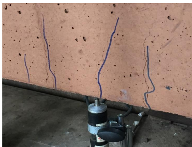
Vết nứt rộng 1,1mm, tương ứng với cấp tải 37kN
