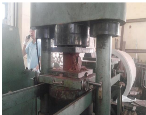
Hình 1. Chế tạo và nén kiểm tra cường độ mẫu bê tông
