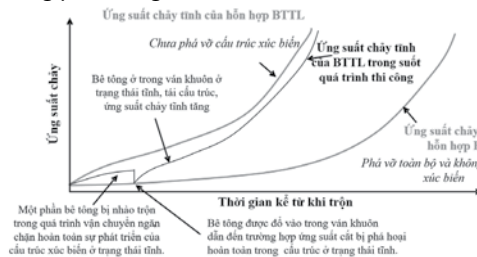
Hình 2. Sự thay đổi ứng suất chảy của hỗn hợp BTTL trong quá trình vận chuyển và thi công. [4]
