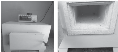
Hình 2. Lò nung thí nghiệm nung mẫu
