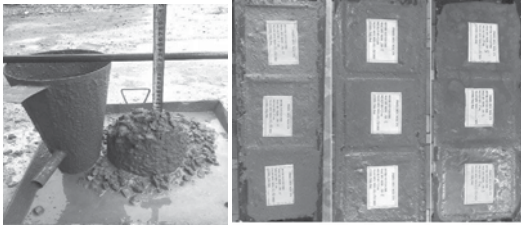
Hình 1. Kiểm tra độ sụt và chế tạo mẫu thí nghiệm
