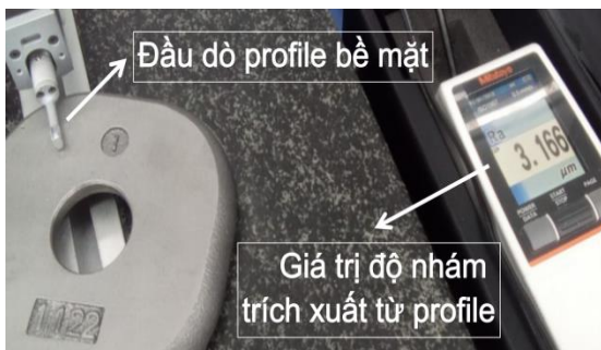
Hình 1. Giá trị độ nhám được trích xuất từ profile bề mặt của chi tiết máy
