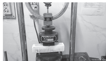
b) - Thí nghiệm cường độ kéo uốn
