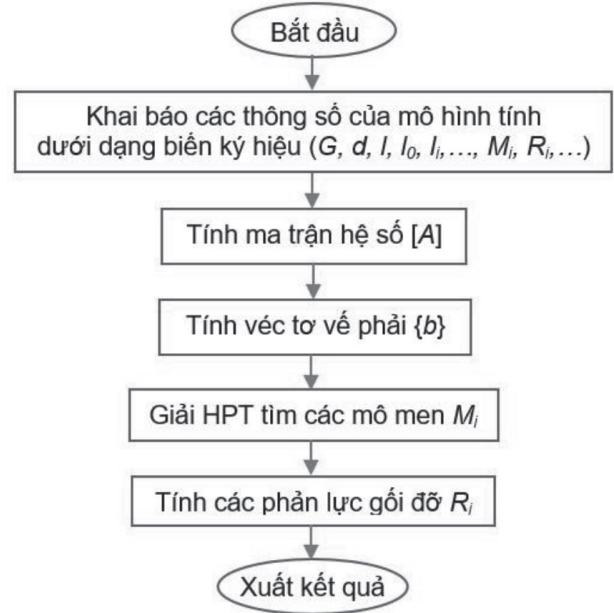
Hình 2.2: Sơ đồ thuật toán sử dụng tính toán biểu tượng tìm công thức giải tích của phản lực gối đỡ
