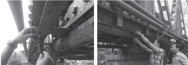
Hình 4.4: Khảo sát đo đặc chiều dày thanh giàn
