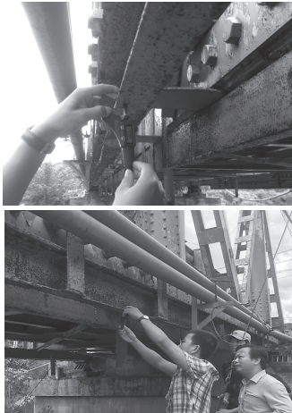
Hình 4.4: Khảo sát đo đạc chiều dày thanh giàn
