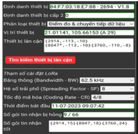
Hình 11. Cài đặt cấu hình thông tin trên thiết bị tại đê cầu vượt sông Đáy.
