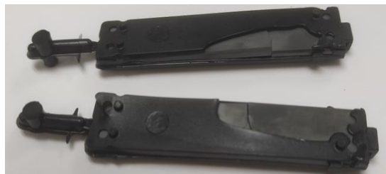
Hình 8. Hiện tượng gãy, nứt sản phẩm sau khi tạo lớp vỏ bảo vệ
