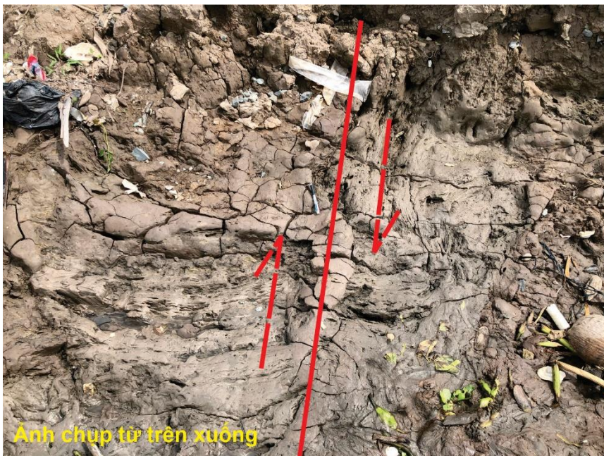
Hình 2. Hoạt động của đứt kiến tạo hoạt động dọc theo đứt gãy Sông Tiền làm dịch chuyển, biến dạng các thành tạo trầm tích trẻ tại vị trí khảo sát có tọa độ 10°19'28.0" - 106°14'42.0".
