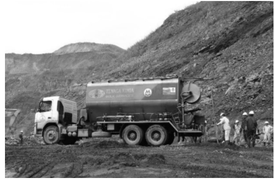
Hình 8. Nạp thuốc nổ nhũ tương rời xuống lỗ khoan bằng thiết bị chuyên dụng
