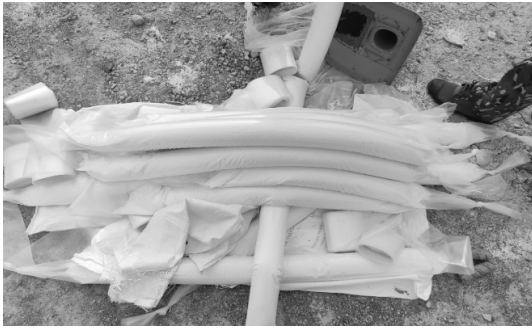
Hình 11. Nạp thuốc nổ vào túi nylon tại mỏ đá Trà Đuốc Lớn
