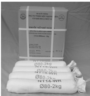
Hình 7. Thuốc nổ nhũ tương bao gói dùng cho lỗ khoan Ø80 mm-2 kg
