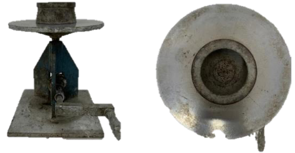
Hình 2. Bàn dần và côn đo độ chảy loang.
