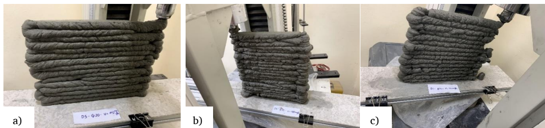
Hình 9. Đánh giá khả năng xây của hỗn hợp bê tông in với với tỷ lệ N/CKD = 0,35 và các tỷ lệ C/CKD khác nhau: (a) 0,67, (b) 1,0, (c) 1,5.
