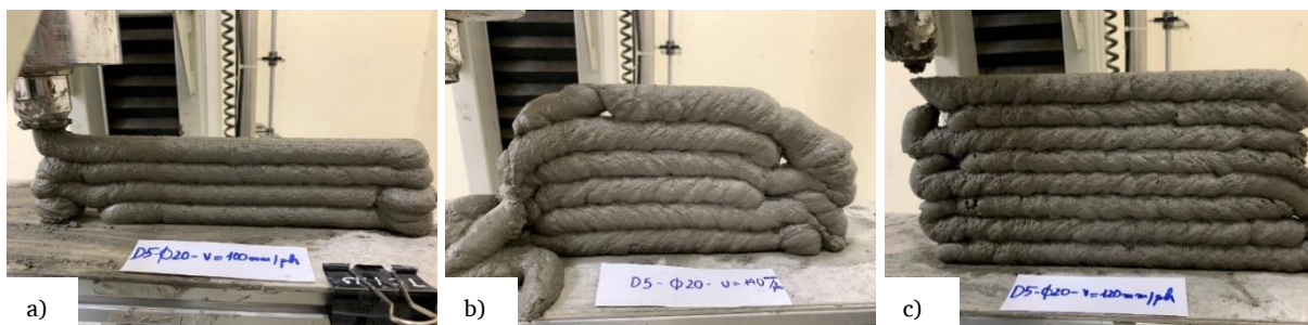
Hình 10. Đánh giá khả năng xây của hỗn hợp bê tông in với với tỷ lệ N/CKD = 0,40 và các tỷ lệ C/CKD khác nhau: (a) 0,67, (b) 1,0, (c) 1,5.
