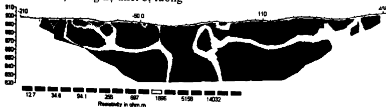
Hình 7. Kết quả phân tích tài liệu đo sâu điện trở tuyến T1-3 khu vực xã Nậm Loông, thị xã Lai Châu bằng hệ thiết bị lưỡng cực.
