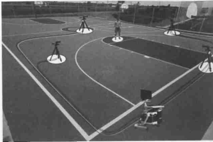
Hình 2. Bố trí hệ thống thiết bị ghi hình Simi Motion 3D trong phân tích kỹ thuật nhảy ném rổ 1 tay trên cao
