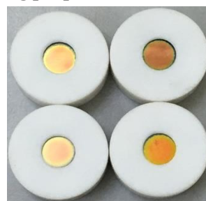
Hình 5. Ảnh chụp các mẫu buồng vi cộng hưởng 1D hoạt động trong vùng nhìn thấy ở các bước sóng cộng hưởng khác nhau
