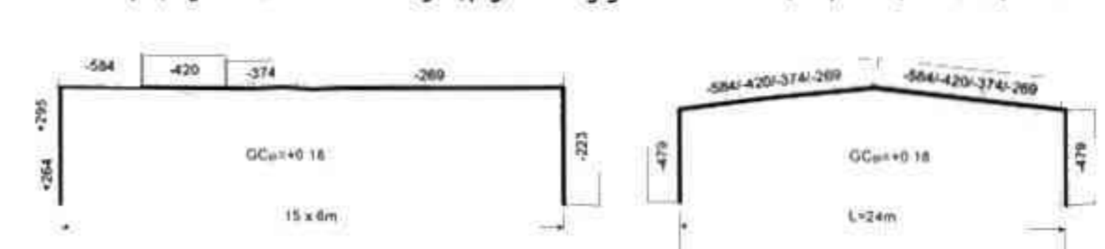
Hình 4. Áp lực gió thiết kế của trường hợp gió song song với đỉnh mái, GC_{pi} = +0,18 .
