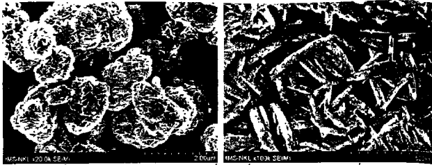
Hình 2. Ảnh FESEM các hạt oxit coban xốp có cấu trúc nanoplate liên kết hướng tâm.
