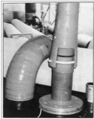
rung của nhựa nền sử dụng. Khả năng chịu mài cao hơn rất nhiều so với bất kỳ vật liệu ống kim loại nào.
