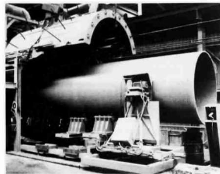
Sợi thủy tinh dạng vải dệt và dạng tấm sợi ngắn thường được sử dụng trong công nghệ này. Hàm lượng sợi sử dụng thông thường từ 20 - 35% khối lượng. Để đạt được độ cứng cao hơn có thể sử dụng hàm lượng sợi cao hơn bằng cách sử dụng loại vải dệt có độ chật cao hơn hoặc sử dụng tốc độ cao hơn để tăng độ nén chật.
